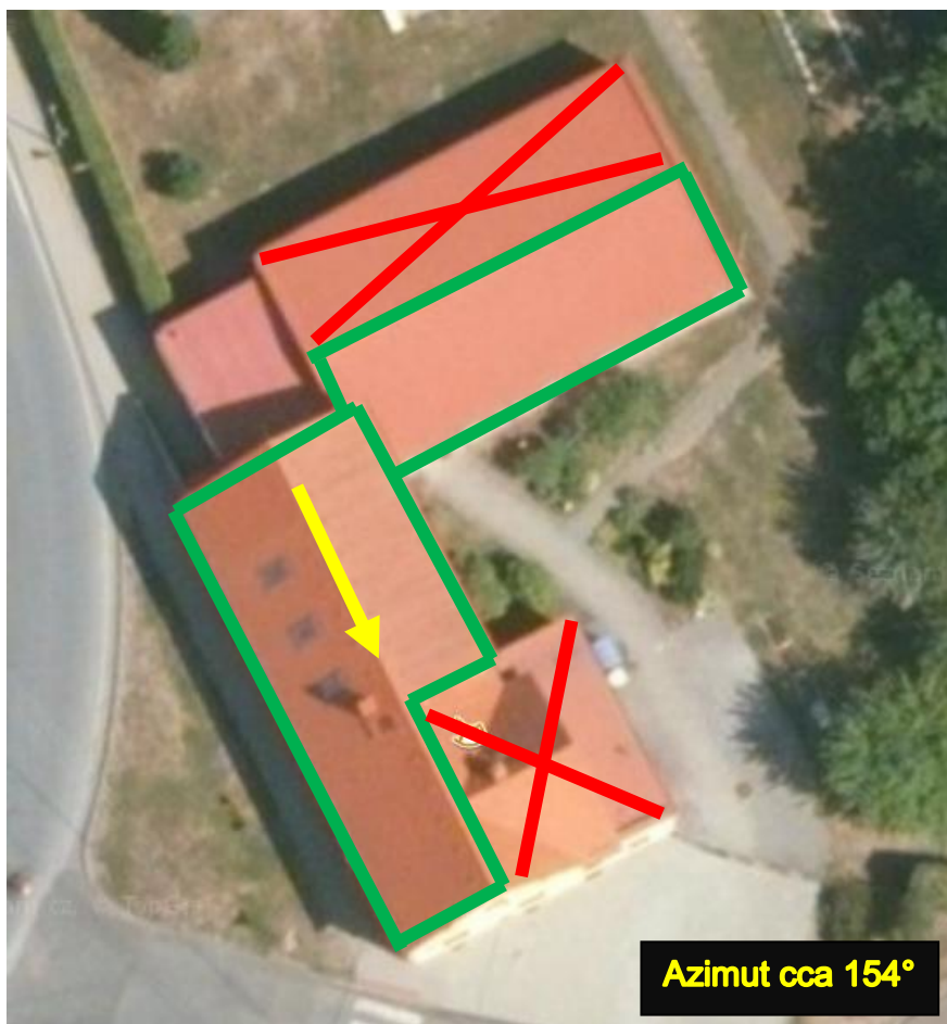
Obrázek 11: Mateřská škola – střecha pro FVE
