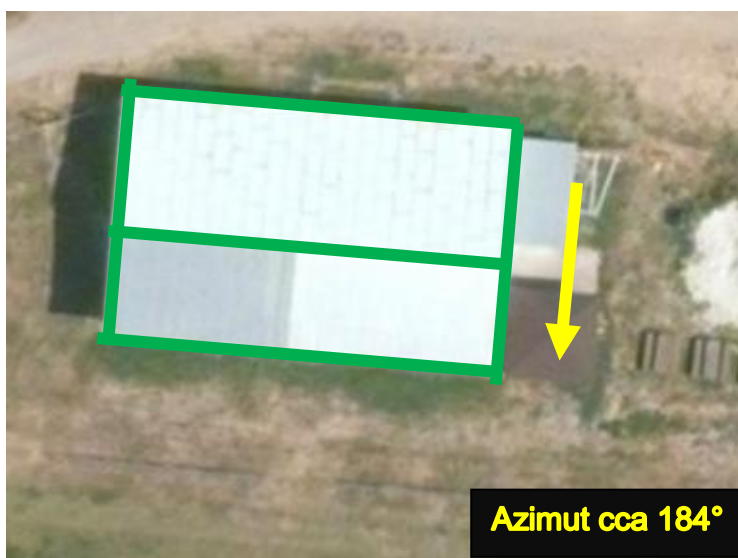
Obrázek 26: Fotbalové kabiny – střecha pro FVE
